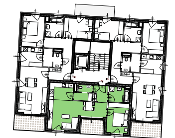
GESCHOSSÜBERSICHT ERDGESCHOSS HAUS D3
